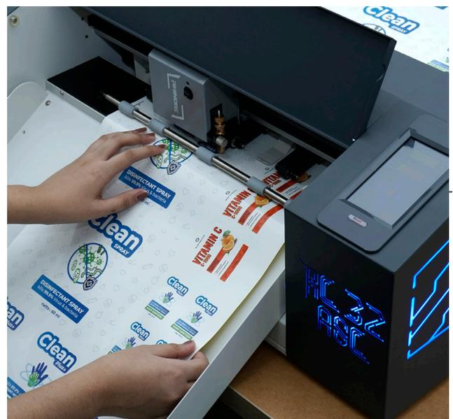
Untuk membantu mempercepat proses pengadaan produk-produk kesehatan ini, Rhino menghadirkan solusi agar proses cutting label produkmu semakin cepat. Rhinotec RC 32 Asc merupakan mesin cutting label dan sticker yang mampu membuat proses pemotongan produk label jadi lebih efisien. Dilengkapi dengan kemampuan cutting label hingga 100 lembar non-stop dalam 1 tray, hingga tingkat presisi yang sangat
